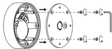
出荷時は蓋が商品に取付けられていますので、蓋を外して穴位置の確認をしてください。
