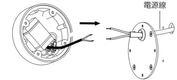
適切な圧着端子及びコネクタを使用して、確実に接続してください。
