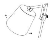
セード上部のつまみネジを締め、 角度が固定されたことを確認します。
