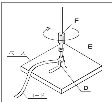
コードをベースの切り欠き部（D）に合わせ、保護ブッシュ（E）を差し込みます。器具を保護ブッシュの上に乗せて、固定ナット（F）で支柱を固定します。保護ブッシュの差し込みや締付けに不備がありますと、感電・転倒・火災等の原因となります。
