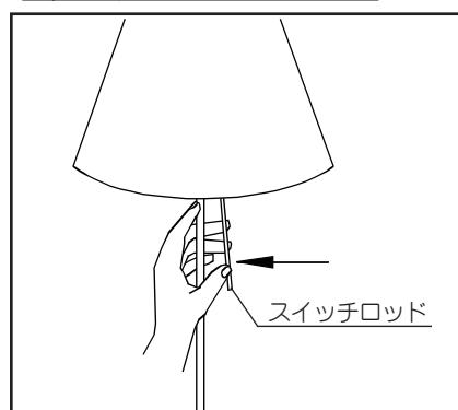
上図のようにスイッチロッドを静かに支柱の方に押すと、ON-OFFの切替えができます。（長期に渡ってご使用にならない時は、コンセントから電源プラグを抜いてください。）
