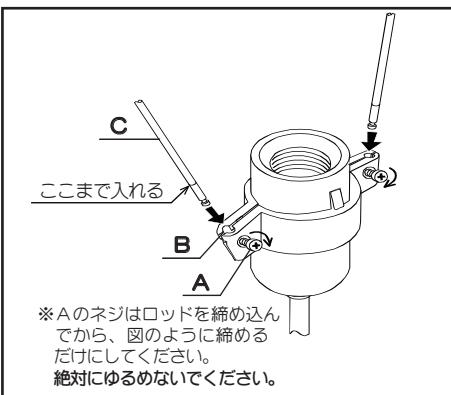
※Aのネジはロッドを締め込んでから、図のように締めるだけにしてください。
