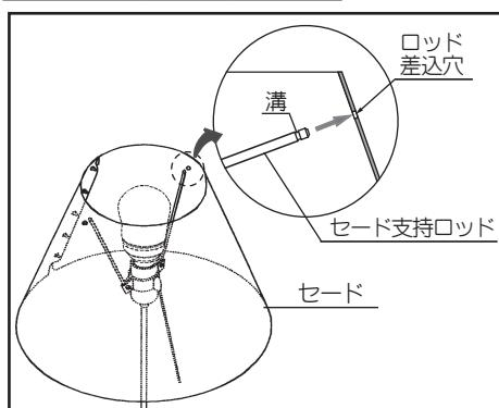
セードにあいた、ロッド差込穴にセード支持ロッドを差し込み、溝の部分で止めます。
