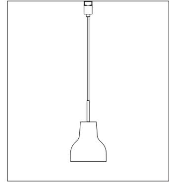
注記) 適合ランプ：口径 E17・白熱灯クリプトン球 60W
