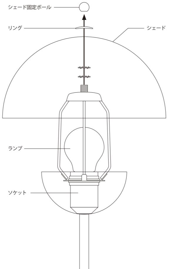
シェード天面の固定用ボールを回すとその下のリングとシェードが本体から外れますので、その状態でランプ(電球)の交換を行ってください。
