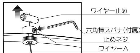
器具出荷時には、器具バランスを調整した状態でお届けしておりますが、長い間お使いのうちに、ワイヤーが次第に伸びて調整ネジを締めてもバランスが取れないことがあります。この場合、左図に示すようにワイヤー取付ネジの止めネジを付属の六角棒スパナでゆるめ、ワイヤー止めを引っ張りバランスを調整したのち、再びワイヤーを止めネジで固定してください。
