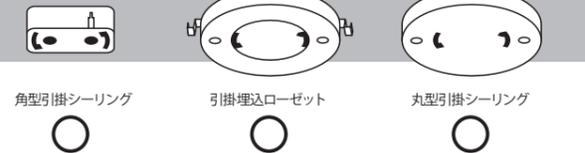
●上面のシーリングボディがついていない場合は、専門の電気工事店へご依頼してください。シーリングボディの取付け電気工事の際は十分な長さの取付けネジ 2 本で天井の補強材のある位置に取付けてください。
